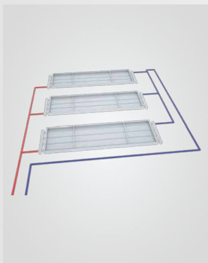
Rys. 1: Ułożenie rur według systemu Tichelmanna
